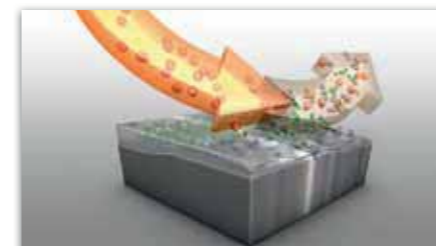
Charges fines éliminées par de grosses particules
