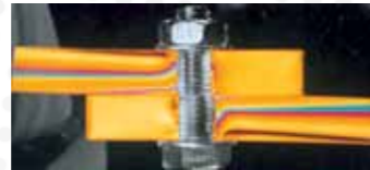
Concentration de contraintes de part et d'autre du boulon (lumière polarisée)
